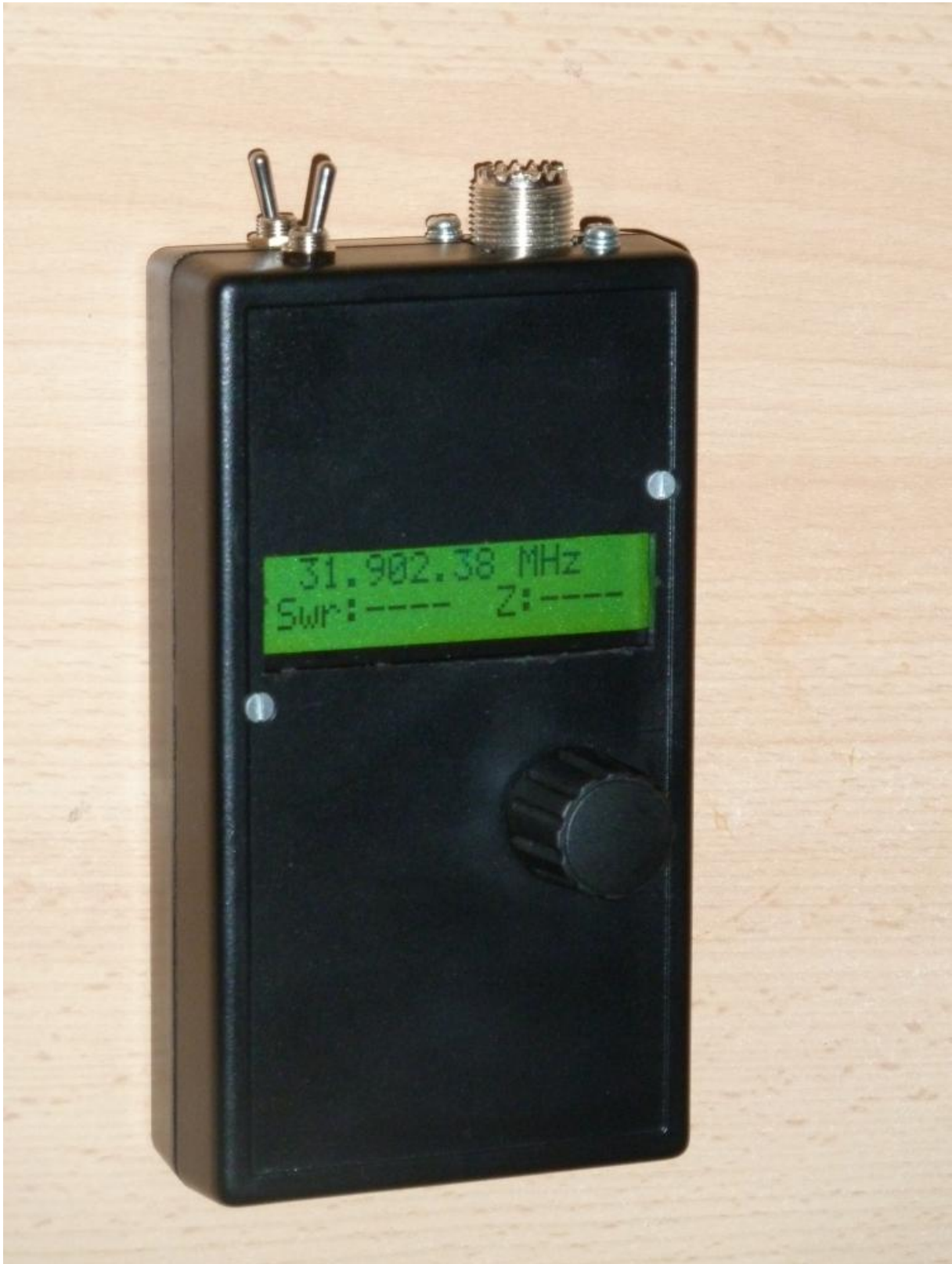
HF antenne-analyser 0.1-33 Mhz bouwpakket FRAG 2013
